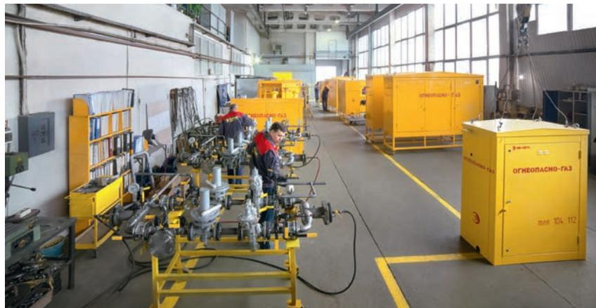
можность разделить оборудование на несколько модулей для транспортировки заказчику, позволила запустить в серийное производство ПГБ с диапазоном входного давления от 0,025 до 1,2 МПа, расходом газа до 400 тыс. м<sup>3</sup>/ч и диаметром трубы до 700 мм.
